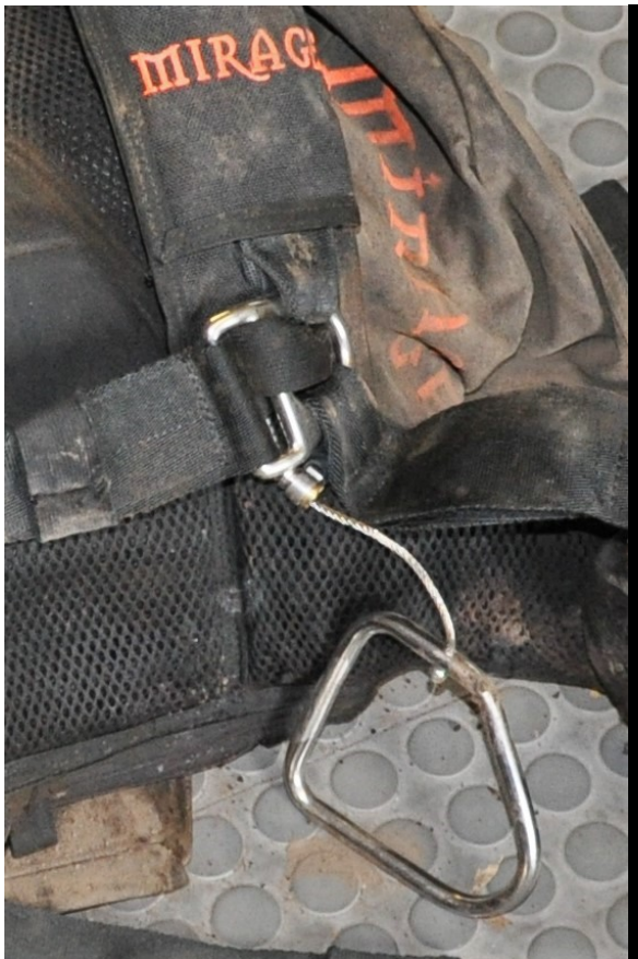
Слика 4. и 5. Затечено стање рукохвата и пина ручице за активирање резервне куполе
