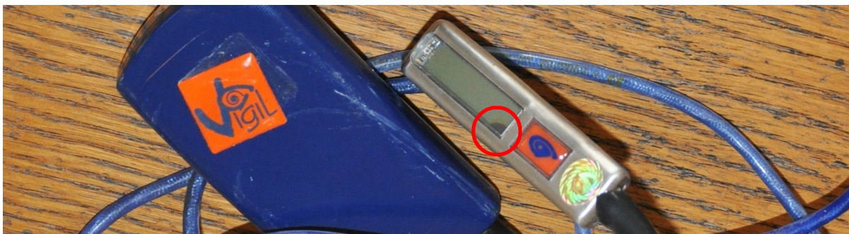
Слика 6. Оштећење дисплеја AAD у десном доњем углу (разливен течни кристал)
