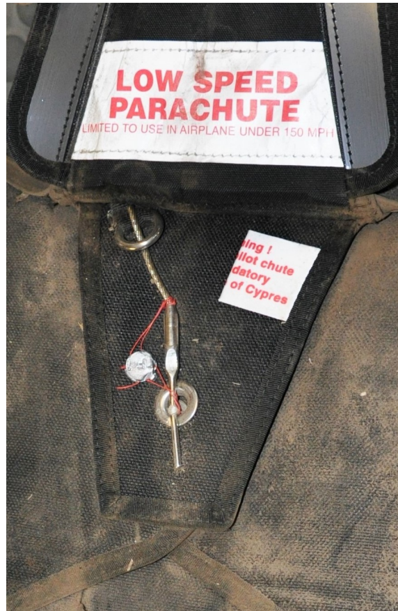
Слика 4. и 5. Затечено стање рукохвата и пина ручице за активирање резервне куполе
